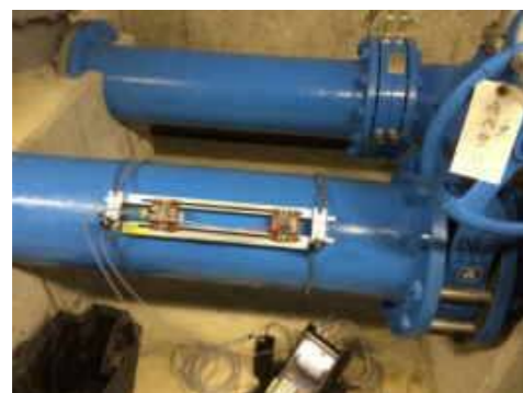
流量調査 (ポータブル超音波流量計)
