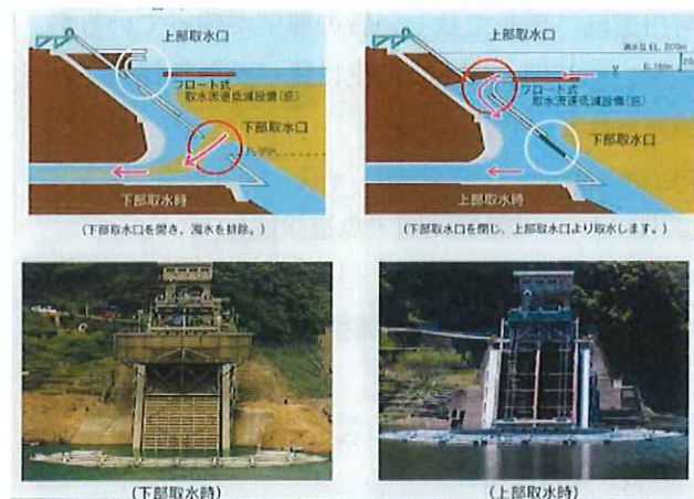
図 5-3-2 一ツ瀬ダム選択取水設備の仕組み
