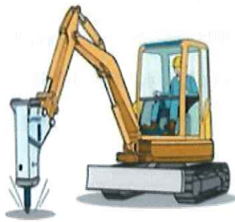
図 3-3-5 ブレーカー掘削機
