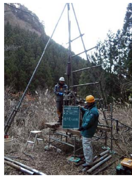
地質測量(標準貫入試験)
