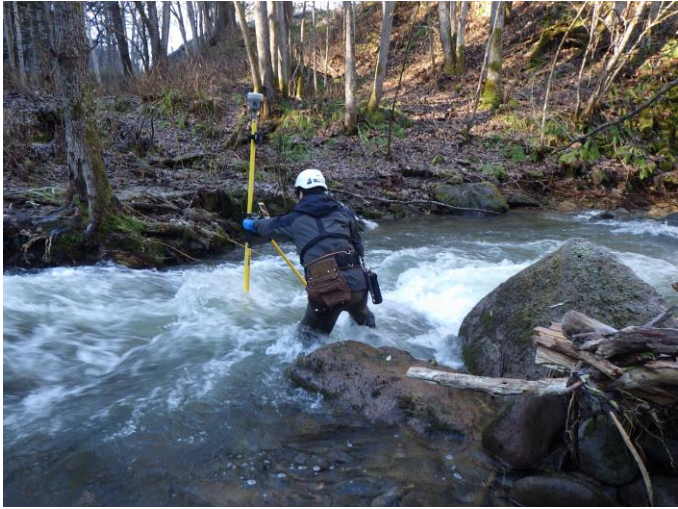
地形測量状況（河川縦断測量）
