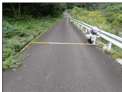
進入路幅員調査
