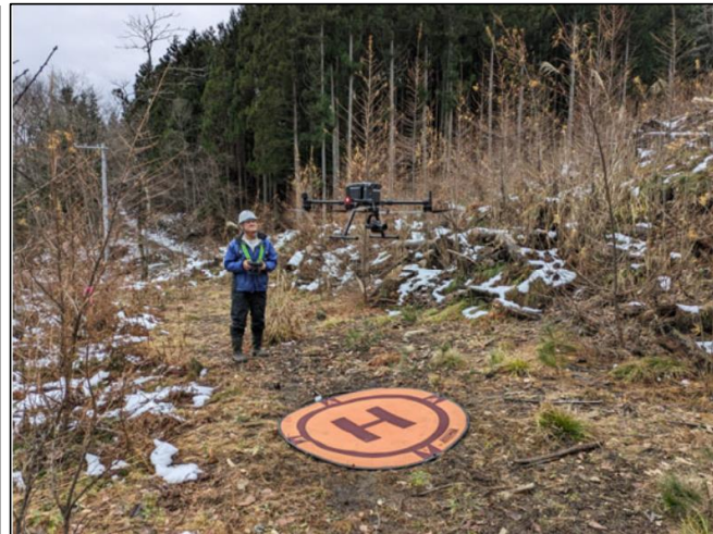
UAVレーザー 地形測量
