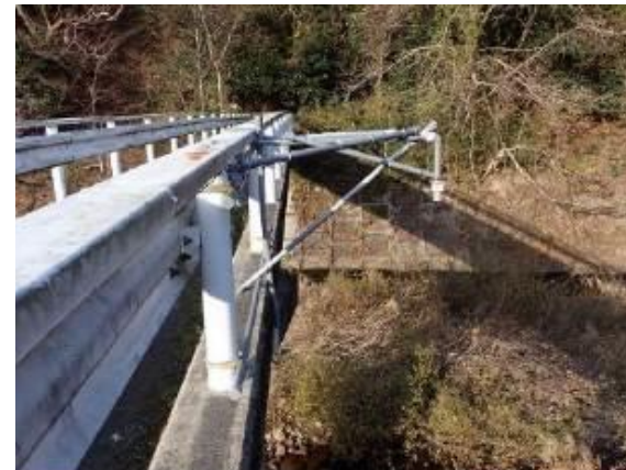
超音波式水位計による水位観測
