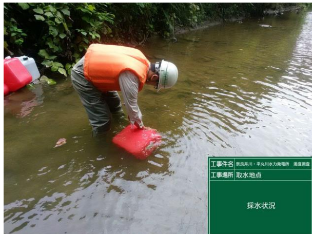
写真3 濁度調査:平水時採水作業
