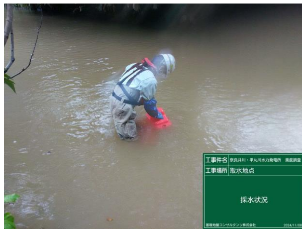
写真4 濁度調査:高水時採水作業
