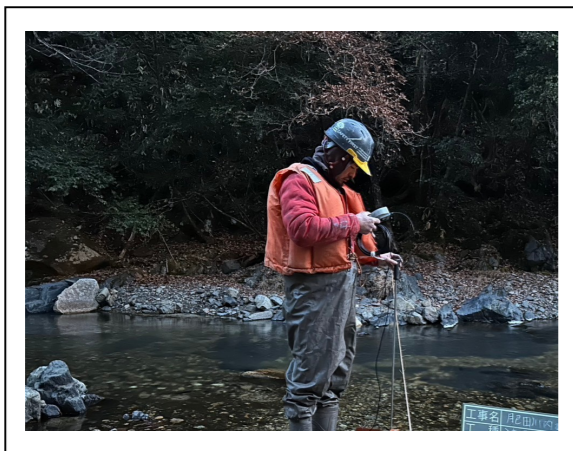
流速計を使用して河川水量を計測
