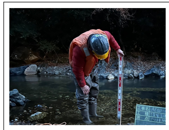
定尺を使用して河川の水位を計測
