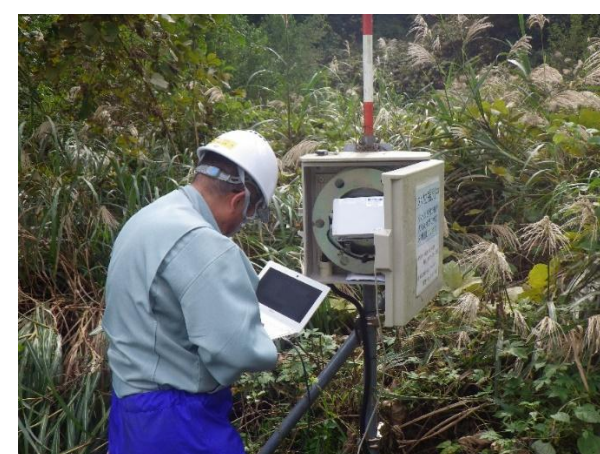
流量調査（水位計データ回収）（青田）
