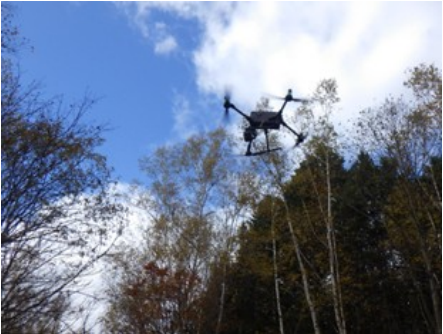
UAV レーザ測量
