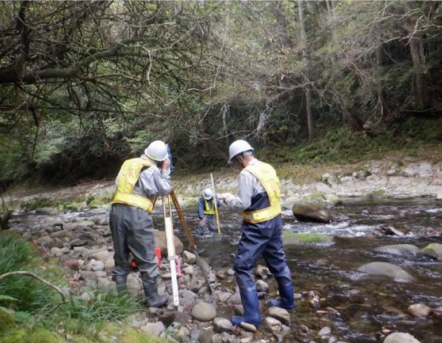
写真3:地形測量(河川測量)
