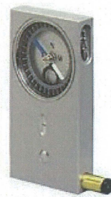
写真 3-3-3 クリノメーターの例
