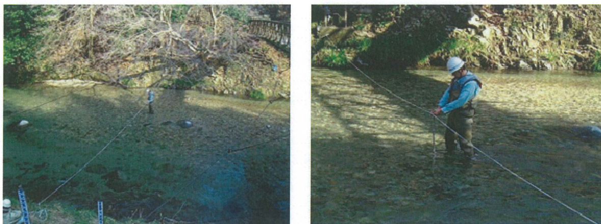
写真 3.4.2 徒渉による流量測定状況
